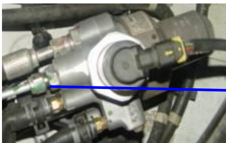
لوله high pressure
